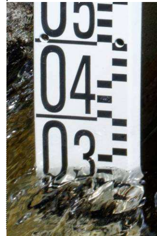
L'échelle limnimétrique permet de contrôler les enregistrements de la sonde (Photo A. M.)
