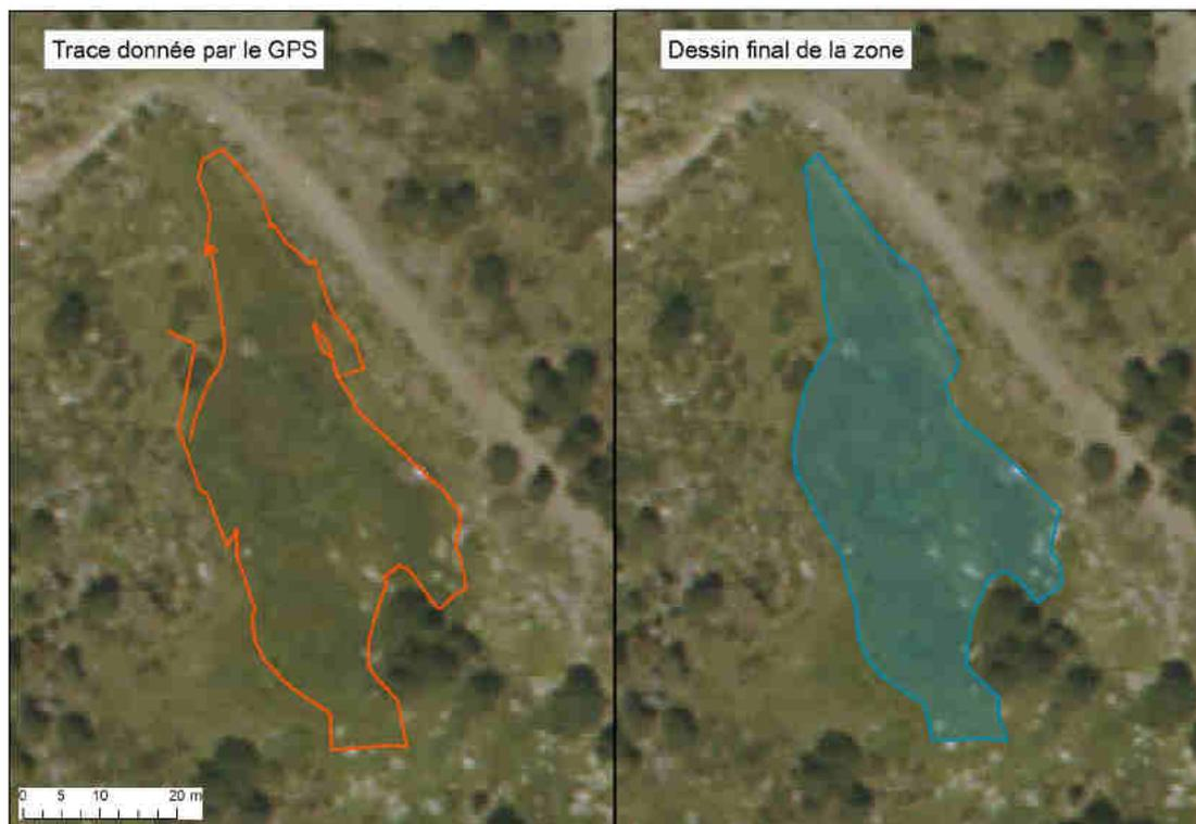
Figure 5. Délimitation des zones à partir des traces relevées au GPS et d'un lissage sur ArcGIS.
